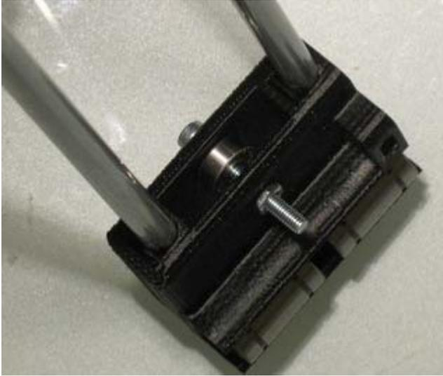
6) Atornillamos 1 motor NEMA17 en el x-end del motor y colocamos la **polea** en el eje del motor NEMA17.
