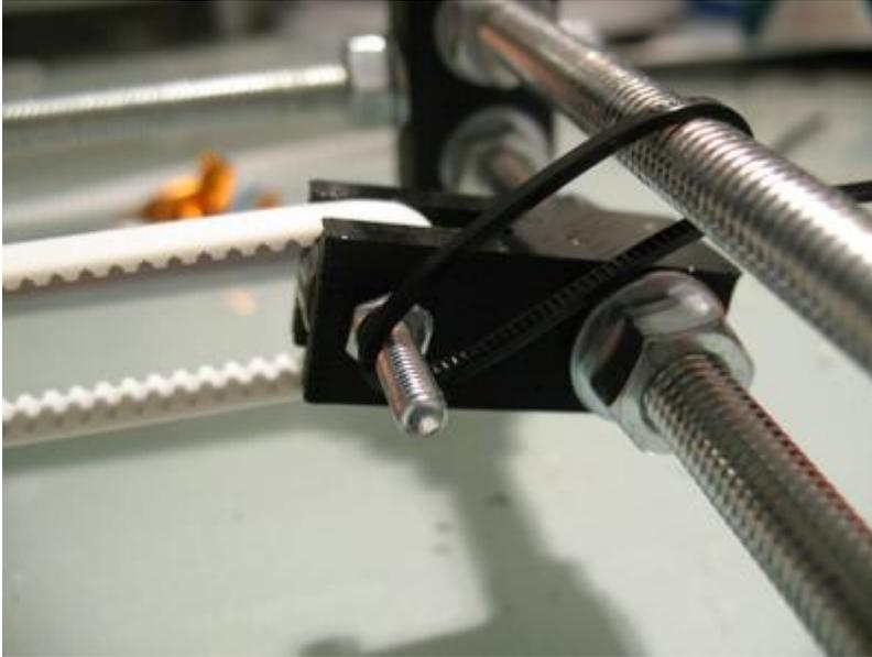
16) Le damos la vuelta a toda la estructura y comprobamos que la base de madera se desliza con la correa suavemente. Debe sentirse el toque de la retención paso a paso de la correa.
