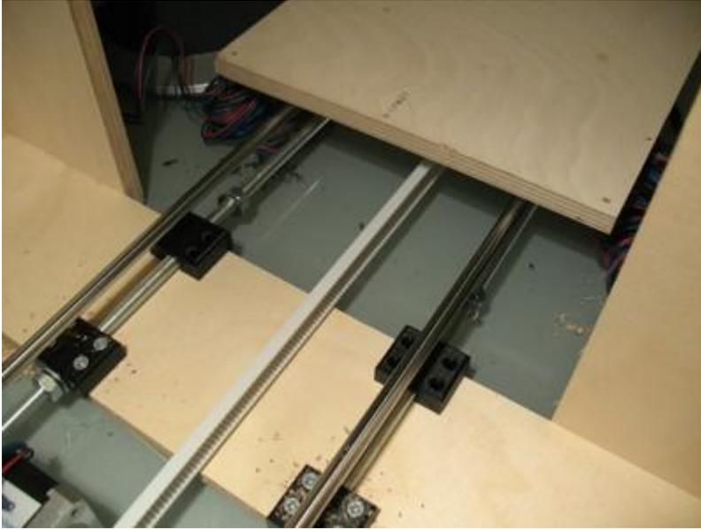
18) Por último ajustamos las **4 tuercas** que quedaron sueltas en el interior de las **varillas roscadas** para fijarlas a los **y-axis-brackets**.
